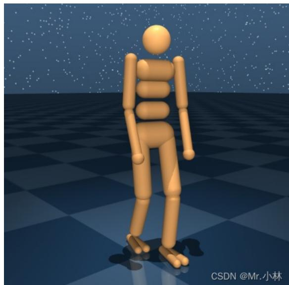
**人型机器人 (Humanoid)**：具有 28 个自由度和 21 个切割关节。主要奖励获得是受到一个主要与其沿 x 轴速度成正比的奖励，以及每一步的恒定奖励，连同跌倒时回合终止，鼓励它不要跌倒。
