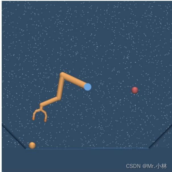
**记忆机械臂 (Memory reacher)**：一个简单的 2 DoF 机械臂被限制在平面上。为回合的前 10 步提供目标位置，在此期间不允许移动手臂。当允许手臂移动时，目标已经消失，必须依靠循环神经网络 RNN (Recurrent neural networks, RNN) 记忆才能使手臂到达正确的目标位置。该任务的奖励是末端执行器和目标位置之间的距离，选择该任务能够测试 DPPO 算法优化循环神经网络策略的能力。
